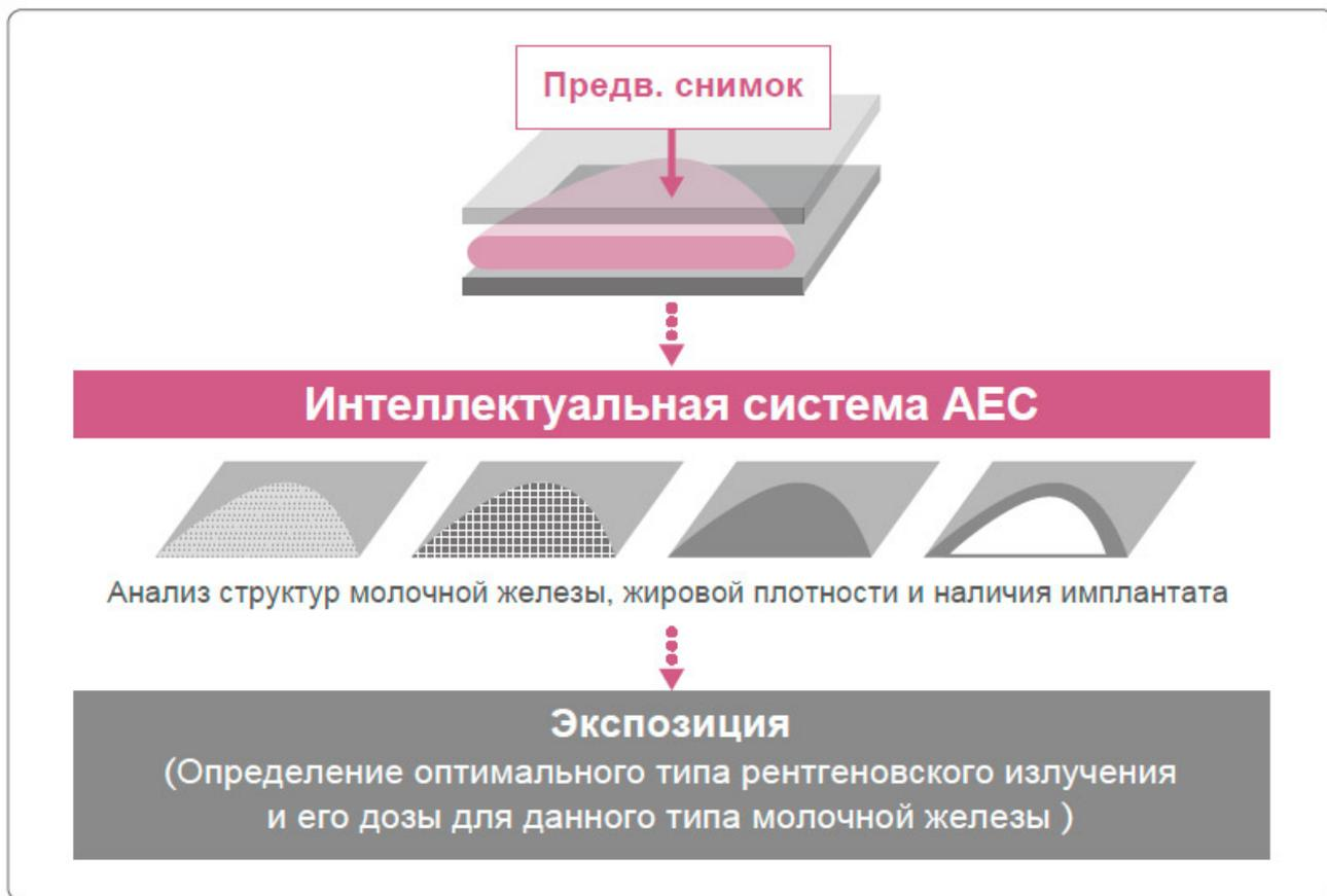
Интеллектуальная система автоматического контроля экспозиции (АЕС) обладает преимуществами при определении оптимальной дозы для исследования по сравнению с обычными системами автоматического контроля экспозиции, в которых положение датчика фиксировано
